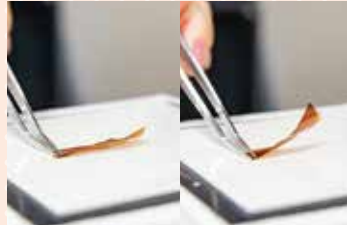
光を浴びて変形するアモルファス窒素化炭素薄膜。配線がなくても光が届けば動かせるところが魅力
