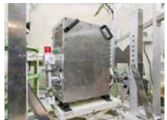
実験室で開発中の近赤外線3波長同時観測カメラ
