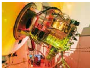
現在、1m望遠鏡で試験観測中の分光観測装置
