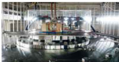
鹿児島大学小山研究室で開発した実験装置を東北大学の20T強磁場発生装置に設置。この装置で世界最高磁場中の高温熱処理—急冷が可能になった。
