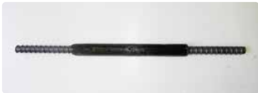
2本の鉄筋をつなぐ炭素繊維スリーブ(中央の黒いチューブ)。鉄筋はスリーブとエポキシ樹脂接着剤で接合されている。両側の鉄筋を引っ張ると、スリーブで覆われていない鉄筋が破断するほどの性能をもつ
