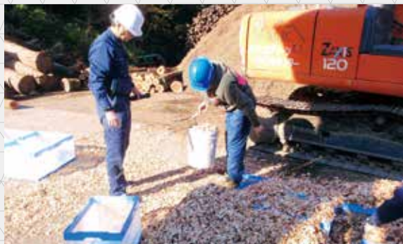
鹿大病院のチップボイラーに使用する木質燃料チップの含水率を測定する学生
