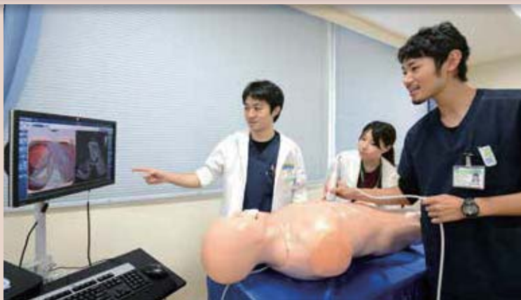
バーチャルリアリティ心臓・腹部超音波トレーニングシミュレータ
