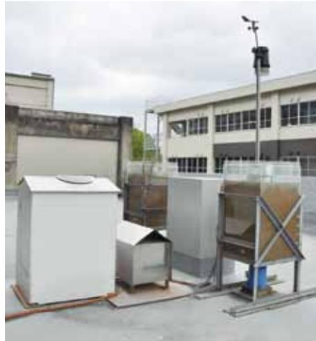
大学構内に設置された、斜面崩壊予知システムの妥当性を検証するためのデータを収集する実験装置。植生ありなしの2つの土槽とライシメーターなどを設置し、気温、土の温度、日射量、風向、風速、排水量などを計測し、水の浸透・蒸発の状態を調べている
