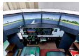
実機で飛行した後は操縦訓練装置を使って振り返り検証を行い、操縦技術の向上を図る
